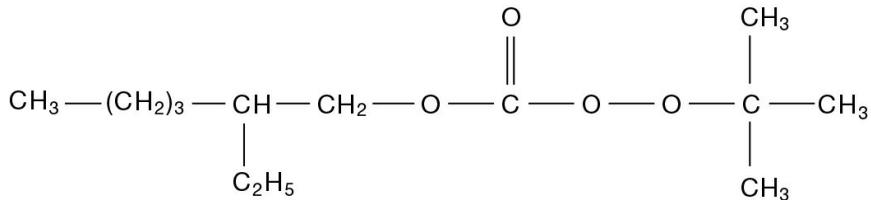
Trigonox 117 是一种脂肪族碳酸酯过氧化物。在升温条件下用于不饱和聚酯树脂的固化，专门用于不饱和聚酯树脂的热压成型工艺(SMC、BMC、DMC)，在BMC中可以降低VOC。
