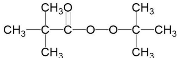
Trigonox® 25-CL25 是一种引发剂(异十二烷中含有 25% 活性成分), 用于乙烯(共)聚合。可用于管式和高压釜工艺。在大多数情况下, 会与其他过氧化物结合使用, 以确保广泛的反应范围。
