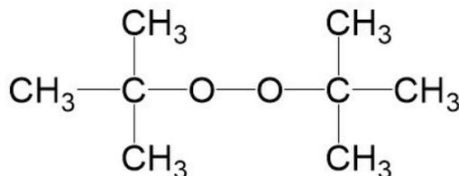
Trigonox® B-CL75 是用于LDPE生产的一种有效引发剂，可用于管式法和釜式法工艺。在大多数情况下，使用与其他过氧化物的组合来确保广泛的反应范围。
