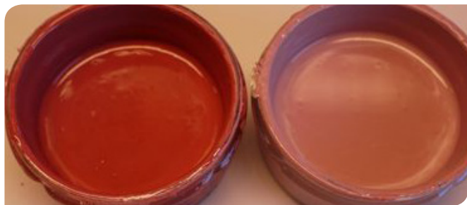
添加色浆的醇酸树脂涂料。左罐：在基础漆中添加1% Phosphol an PE169的效果。
